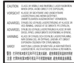
Die Tonabnahmeeinheit dieses Geräts wurde als Laser-Gerät der Klasse 3R (CLASS 3R LASER) klassifiziert. Bei geöffnetem Laser-Schutzgehäuse tritt sichtbare und unsichtbare Laserstrahlung aus. Setzen Sie Ihre Augen auf keinen Fall direkt dem Laserstrahl aus. Der entsprechende Hinweis befindet sich außen an der Unterseite des Hauptgeräts.
