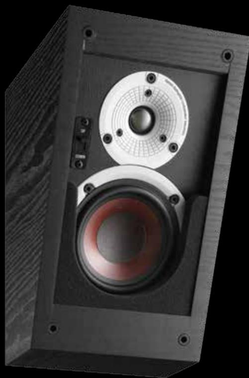
Die von DALI eingesetzten Lautsprecher-Technologien ermöglichen eine tiefe Übergangsfrequenz der Hochtonkalotte zum Tiefmitteltöner. Dessen rötlich schimmernde Membranen bestehen aus Papier und Holzfasern, wodurch eine ungleichmäßige, unerwünschte Resonanzen minimierende Oberflächenstruktur entsteht.
