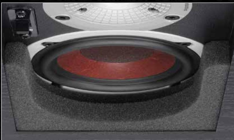
Um zu vermeiden, dass die abgegebenen Schallwellen durch die zurückversetzte Schallwand unvorteilhaft reflektiert und gebrochen werden oder ein Trichtereffekt auftritt, ist rund um den Tiefmitteltöner ein speziell geformtes Schaumstoffpolster eingebracht, das unabhängig von der Platzierung und Verwendung des ALTECO C-1 auf jeden Fall an dieser Stelle verbleiben sollte.
