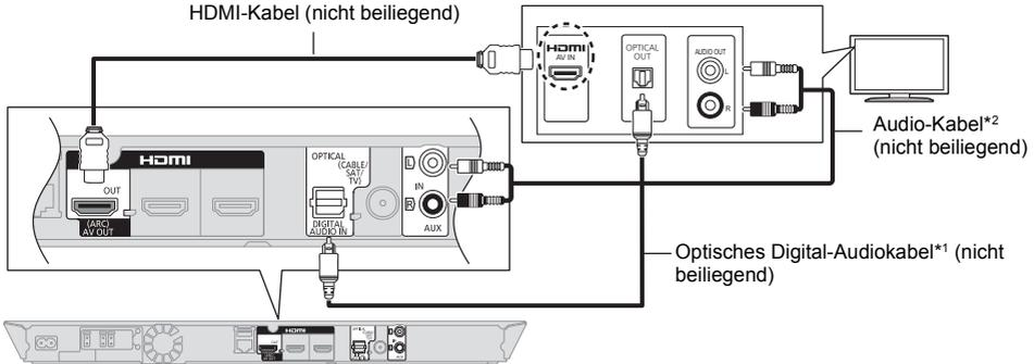
\*<sup>1</sup> Wenn der HDMI-Anschluss am Fernseher mit "HDMI (ARC)" gekennzeichnet ist, ist der Anschluss des optischen Digital-Audiokabels nicht erforderlich.
