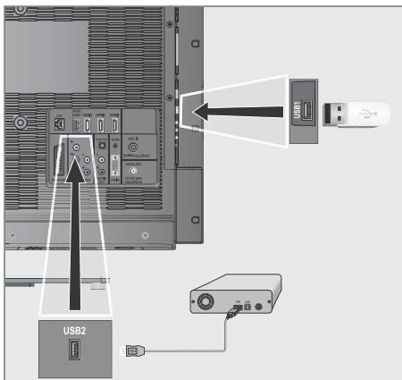
1 Buchse »**USB2 (HDD)**« des Fernsehgerätes und entsprechende Buchse des Datenträgers (externe Festplatte) mit einem USB-Kabel verbinden;
