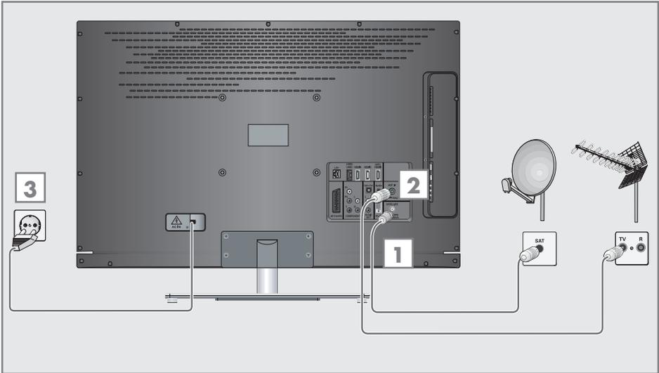
**1** Zum Empfang digitaler Satellitenprogramme (DVB-S) das Kabel der Satellitenantenne an die Antennenbuchse »**SATELLITE**« am Fernsehgerät anschließen.
