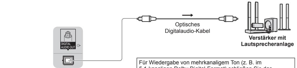
Für Wiedergabe von mehrkanaligem Ton (z. B. im 5.1-kanaligen Dolby Digital-Format) schließen Sie das Zusatzgerät an den Verstärker an. Einzelheiten zu den Anschlüssen finden Sie in den Bedienungsanleitungen des Zusatzgerätes und des Verstärkers.
