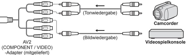
Für den Anschluss an die verschiedenen Buchsen geeignete Zusatzgeräte
