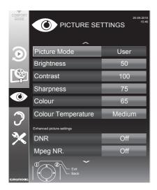
Select the line »Picture Mode«, »Brightness«, »Contrast«, »Sharpness«, »Colour«, or »Colour Temperature« with »V« or »A«. Select the value with »<« or »>« and press » « to confirm.
