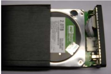
Schieben Sie den inneren Rahmen aus dem Gehäuse. Montieren Sie die Festplatte und befestigen Sie diese mit den mitgelieferten Schrauben.
