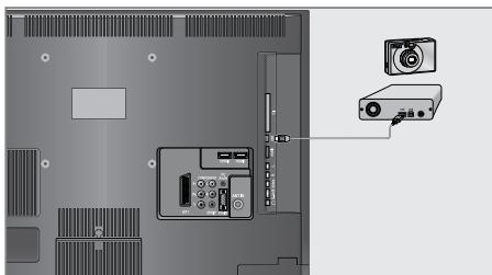
**1** USB-Schnittstelle »**USB**« des Fernsehgerätes und entsprechende Buchse des Datengerätes (externe Festplatte, Digital-Camera, Kartenlesegerät oder MP3-Player) mit einem USB-Kabel verbinden;
