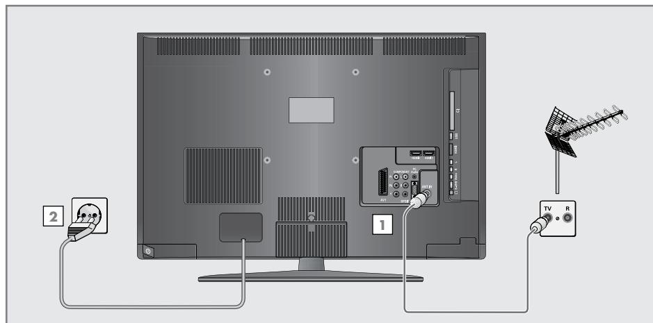
1 Für terrestrische Fernseh-Programme (DVB-T) das Kabel der Haus- oder Zimmerantenne (passive oder aktive Zimmerantenne mit eigener Stromversorgung) an die Antennenbuchse »ANT IN« des Fernsehgerätes anschließen; oder
