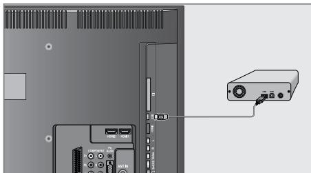
**1** USB-Schnittstelle »**USB**« des Fernsehgerätes und entsprechende Buchse des Datenträgers (externe Festplatte) mit einem USB-Kabel verbinden;
