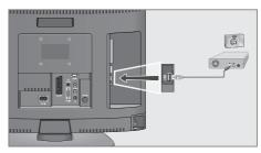
1 USB-Schnittstelle »USB« des Fernsehgerätes und entsprechende Buchse des Datengerätes (externe Festplatte, Digital-Camera, Kartenlesegerät oder MP3-Player) mit einem USB-Kabel verbinden;
