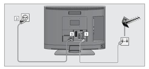
1 Für terrestrisch empfangene Fernsehprogramme (DVB-T) schließen Sie das Kabel der Haus- oder Zimmerantenne (passive oder aktive Zimmerantenne mit eigener Spannungsversorgung) an den Antenneneingang »ANT IN« des Fernsehgerätes an;
