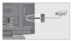
1 USB-Schnittstelle »USB« des Fernsehgerätes und entsprechende Buchse des Datenträgers (externe Festplatte) mit einem USB-Kabel verbinden:
