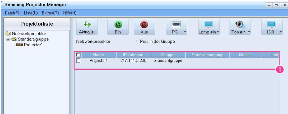
1: Sie können den Name, IP Address, Group, Power On/Off-Status des Projektors sowie LAMP lifespan, Betriebsfehler (angezeigt mit Symbolen) usw. in Echtzeit anzeigen.
