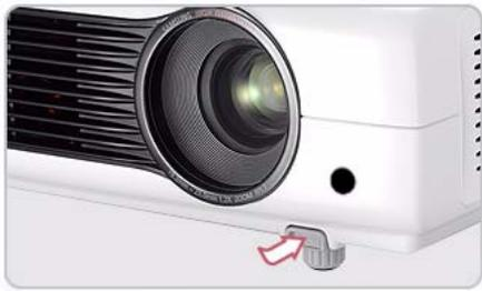
Drücken Sie die mit PUSH gekennzeichneten Knöpfe, um die Beine des Projektors so einzustellen, dass er waagrecht steht.
