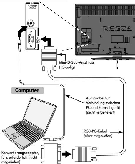
Stellen Sie am PC die Monitorausgangsaufösung ein, bevor Sie den PC an das Fernsehgerät anschließen. Geeignete PC-Signal-Formate finden Sie auf Seite 74.
