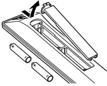
Nehmen Sie die Batterieabdeckung ab, so dass das Batteriefach sichtbar wird, und legen Sie die Batterien mit der richtigen Polarität ein. Geeignete Batterietypen für diese Fernbedienung sind AAA, IEC R03 mit jeweils 1,5 V.
