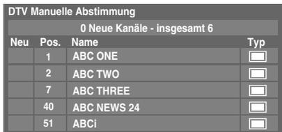
Wenn der Multiplex gefunden wird, werden alle Kanäle, die sich derzeit nicht in der Kanalliste befinden, hinzugefügt und die Kanalinformationen im oberen Bereich des Bildschirms werden aktualisiert.
