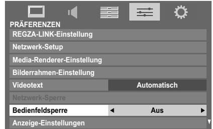
Bei **Bedienfeldsperre Ein** wird eine entsprechende Erinnerungsmeldung angezeigt, sobald eine Taste am Fernseher gedrückt wird. **Das Fernsehgerät wird durch Drücken der Standby-Taste ausgeschaltet und kann dann nur mit der Fernbedienung wieder aus dem Standby-Betrieb heraus eingeschaltet werden.**
