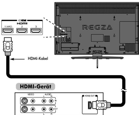
Zum Anzeigen der Videosignale vom HDMI-Gerät drücken Sie die -Taste, um den Modus HDMI 1, HDMI 2, HDMI 3 oder HDMI 4 auszuwählen.
