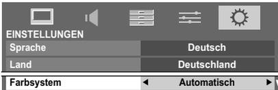
**2** Wählen Sie mithilfe der Taste **◀** oder **▶** eine der folgenden Einstellungen: **Automatisch**, **PAL**, **SECAM**, **NTSC 4.43** oder **NTSC 3.58**.
