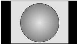
Mit dieser Einstellung kann ein Fernsehbild im 4:3-Format an die Bildschirmgröße angepasst werden, indem es horizontal und vertikal gestreckt wird. Die Größenverhältnisse in der Mitte des Bildes werden dabei besser dargestellt. Es können jedoch gewisse Verzerrungen auftreten.
