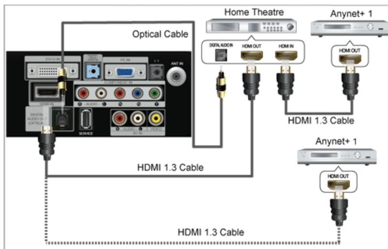
1. Verbinden Sie einen der Anschlüsse **[HDMI IN]** am Fernsehgerät mit dem HDMI OUT-Anschluss am entsprechenden <Anynet+>-Gerät. Verwenden Sie hierfür das HDMI -Kabel.
