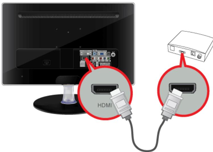
Schließen Sie den [HDMI IN]-Anschluss Ihres Monitors mit einem HDMI-Kabel an den HDMI OUT-Anschluss des AV-Geräts an. Drücken Sie die Taste [SOURCE] auf der Frontblende des Monitors oder auf der Fernbedienung, bis der Modus <HDMI> eingestellt ist.
