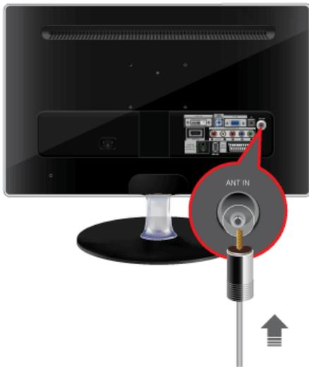
1. Schließen Sie das Kabel-/Satellitensystem oder das Kabel der Fernsehantenne an den [ANT IN]-Eingang auf der Rückseite des Monitors an.
