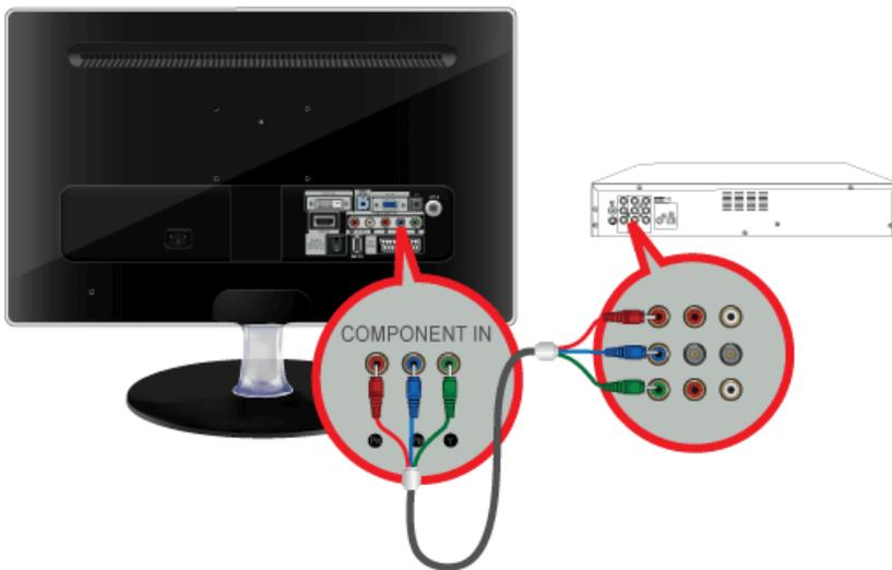
1. Verbinden Sie den VIDEO OUT-Anschluss des AV-Geräts (DVD/Videorekorder/Kabel-/Satellitenreceiver) über ein Komponentenvideokabel (P<sub>R</sub>, P<sub>B</sub>, Y) an die [COMPONENT IN [P<sub>R</sub>, P<sub>B</sub>, Y]]-Eingänge an.
