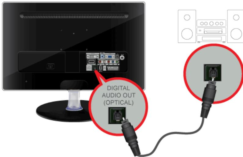
Schließen Sie den [DIGITAL AUDIO OUT (OPTICAL)]-Anschluss Ihres Monitors mit einem optischen Verbindungskabel an den optischen Eingang Ihres Verstärkers an.
