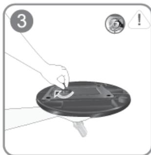
Drehen Sie die Befestigungsschraube unten am Standfuß bis zum Anschlag, damit er sicher befestigt ist.
