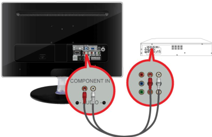
2. Schließen Sie den [COMPONENT IN [R-AUDIO-L]]-Anschluss Ihres Monitors an den Audioanschluss des AV-Geräts (DVD/Videorekorder/Kabel-/Satellitenreceiver) an.
