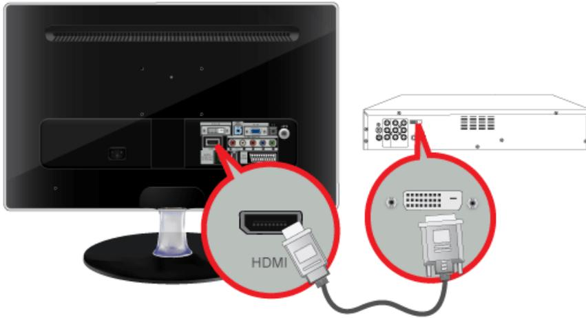
1. Der DVI-Ausgang des externen Geräts und der [HDMI IN]-Anschluss des Monitors werden über das DVI/HDMI-Kabel miteinander verbunden.
