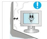
Befestigen Sie das Gerät in mindestens 10 cm Abstand zur Wand, um für ausreichende Belüftung zu sorgen.
