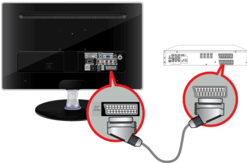
1. Schließen Sie den DVD-Player mit Hilfe einer SCART-Buchse an den EXT(RGB)-Anschluss des Monitors an.
