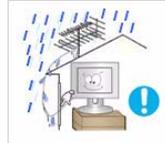
Lassen Sie das Antennenkabel an der Stelle, an der es nach innen geführt wird, in einer Schlaufe nach unten hängen, damit kein Regenwasser eindringen kann.
