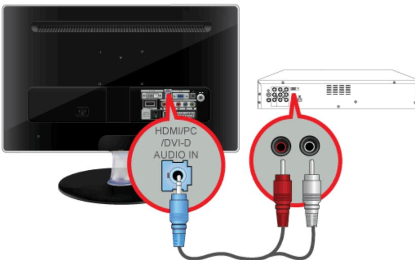
2. Schließen Sie den roten und den weißen Stecker des RCA/Stereo-Kabels (für PC) an die entsprechend gefärbten Audioausgänge des digitalen Ausgabegeräts an, und verbinden Sie den gegenüberliegenden Stecker mit dem [HDMI/PC/DVI-D AUDIO IN]-Anschluss des Monitors.
