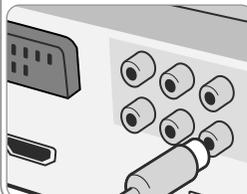
Verbinden Sie die VIDEO OUTPUT (MONITOR)-Buchse am Gerät über ein Videokabel mit den entsprechenden Eingangsbuchsen am Fernsehgerät.
