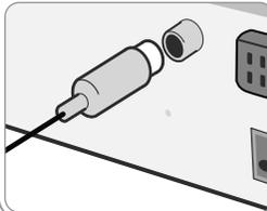
UKW(FM) - Schließen Sie die UKW-Antenne an. Ein optimaler Empfang wird erreicht, wenn die beiden losen Enden der Antenne gerade und waagrecht ausgerichtet werden.
