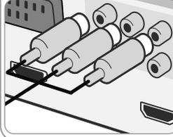
Verbinden Sie die COMPONENT VIDEO (PROGRESSIVE SCAN) OUTPUT-Ausgangsbuchsen am Gerät über ein Y PB PR-Kabel mit den entsprechenden Eingangsbuchsen am Fernsehgerät.
