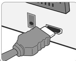
Verbinden Sie die HDMI INPUT-Buchse am Gerät über ein HDMI-Kabel mit der HDMI-Ausgangsbuchse am Digitalempfänger (oder z. B. am Digitalgerät). Drücken Sie die Taste FUNCTION, um die externe Quelle auf HDMI IN einzustellen. Im HDMI IN-Modus kann die Auflösung nicht geändert werden.
