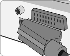
Verbinden Sie die TO TV-Buchse am Gerät über das SCART-Kabel mit dem Fernsehgerät.
