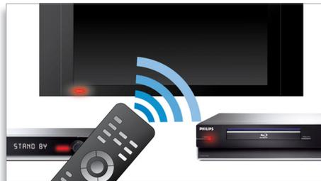
Mit EasyLink können Sie mehrere Geräte über eine einzige Fernbedienung steuern. Verwendet wird hierzu das Industriestandardprotokoll HDMI CEC, das
