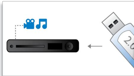
Der universelle serielle Bus, kurz USB genannt, ist ein Standardprotokoll für den problemlosen Anschluss von PCs, Peripheriegeräten und Unterhaltungselektronik. High-Speed USB-Geräte haben eine Datenübertragungsrate von bis zu 480 Mbit/s, im Gegensatz zu den 12 Mbit/s des ursprünglichen USB-Standards. Mit der High-Speed USB 2.0-Verbindung müssen Sie lediglich Ihr USB-Gerät anschließen, den Film, den Musiktitel oder das Foto auswählen und die Wiedergabe starten.
