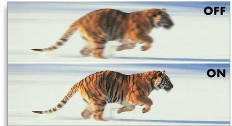
100 Hz LCD erzeugt schärfere Bilder bewegter Objekte, sogar bei schnellen Objektbewegungen auf dem Bildschirm. Hierfür werden Zwischenbilder mit einer hohen Bildwechselfrequenz von 100 Hz eingefügt. Es erhöht die Schärfe der Bewegungsdarstellung um mehr als das Doppelte gegenüber herkömmlichen LCD TVs und führt zu einer Reaktionszeit von 3 ms (gemessen in Perceived BEW, Blur-Edge-Width). Diese einzigartige Philips Technologie liefert eine beispiellose Bewegungsschärfe für LCD TVs.
