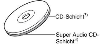
Eine Super Audio CD-Schicht enthält einen 2-Kanal-Bereich und einen Mehrkanalbereich.
