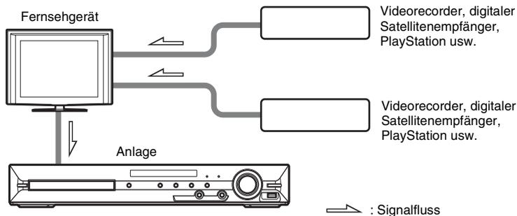
Wählen Sie das Gerät am Fernsehgerät aus. Einzelheiten dazu finden Sie in der Bedienungsanleitung zum Fernsehgerät.
