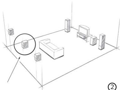
**Enceinte centrale:** Elle est placée à proximité immédiate de l'écran (au-dessus ou au-dessous). Dans un système 6.1, un deuxième haut-parleur central est installé entre les deux satellites placés à l'arrière de l'espace d'audition (fig. 2). Toutes les enceintes centrales Canton sont dotées d'un blindage magnétique. Toute perturbation de l'image télévisée est ainsi exclue.
