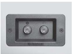
Unterschiedliche Polung zwischen dem linken und dem rechten oder dem Front und Surround Kanal führen zu Klangverfälschungen.
