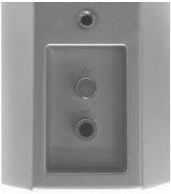
Achten Sie beim Anschluß der Lautsprecher unbedingt auf die richtige Polung. Plus an Plus und Minus an Minus. Sowohl die Anschlußklemmen der Lautsprecher (Pluspol = rot, Minuspol = schwarz) als auch die Anschlüsse des Steuergerätes sind mit entsprechenden Symbolen bzw. Farben gekennzeichnet. Zur einfacheren Orientierung unterscheiden sich auch die Adern der meisten Lautsprecherkabel durch Farbe, Form oder Aufdruck.
