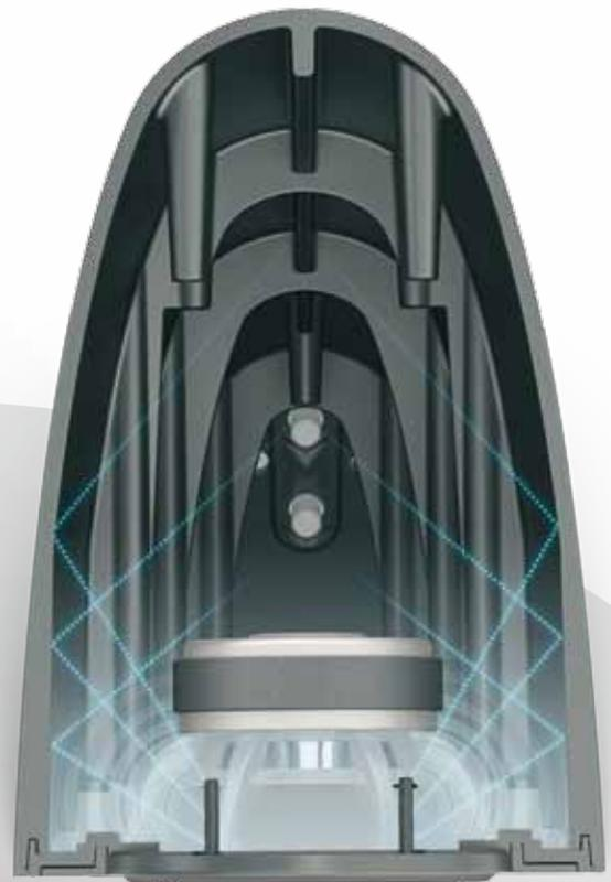
Dank seiner außergewöhnlichen, geschwungenen Form hat das Gehäuse der FAZON F5 keine parallelen Wände, wodurch stehende Wellen im Keim erstickt werden.
