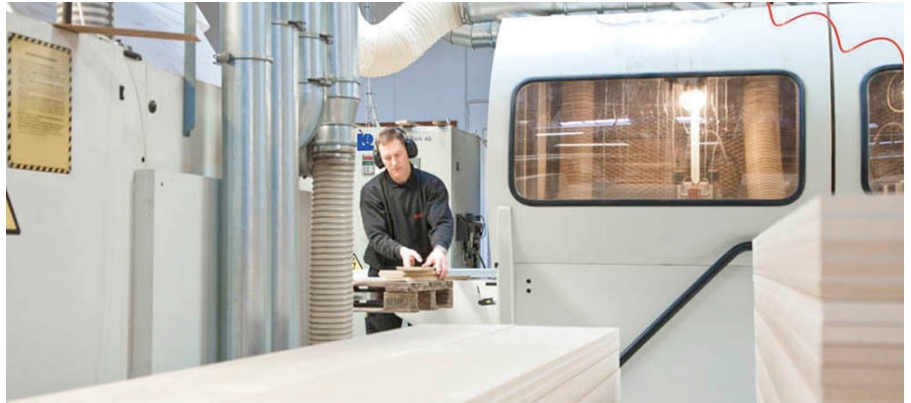
Zuschnitt der MDF-Platten für die OPTICON-Gehäusefertigung.
