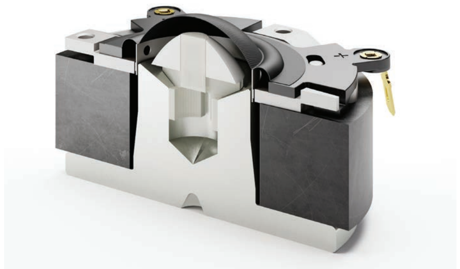
Der Kalottenhochtöner besteht aus einer extrem leichten Kalottenmembran, einem großen Ferritmagneten und einer von ultradünnem magnetischen Fluid gekühlten Schwingspule.
